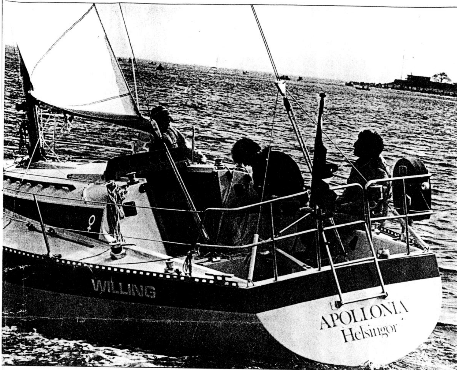
I agterpulpiten er indbygget en badestige som indgår i standardudrustningen.
